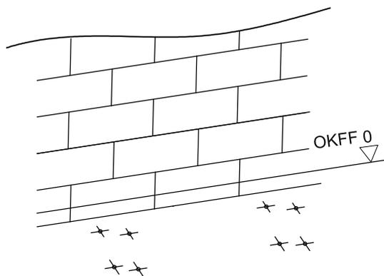
③ Просверлить отверстия диаметром 10 мм и глубиной 55 мм
