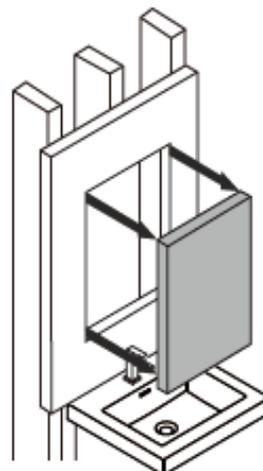
Вырежьте отмеченный периметр при помощи подходящего инструмента
