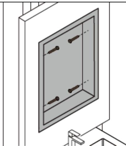
Закрепите шпильки с помощью крепежных винтов
