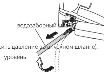
Нажмите кнопку "Обезжиривание форсунки" (чтобы сбросить давление во впускном шланге).
