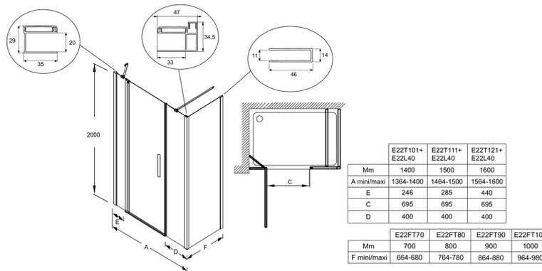
Спецификация продукта: Распашная дверь 120 см. E22T121. Коллекция: CONTRA. РАЗМЕРЫ (СМ): 200x120 см. ВЕС: 43 кг. МАТЕРИАЛ: N/A. УСТАНОВКА: Угловые. МИН/МАКС ШИРИНА С ФИКСИРОВАННОЙ ПАНЕЛЬЮ: 116,4 - 118,2 см. ПРОЕМ: 65. ШТАНГА: Требуется: горизонтальная. УСТАНОВКА: Закрытое пространство. ТОЛЩИНА СТЕКЛА В ММ: 6. ТИП ДУШЕВОГО ОГРАЖДЕНИЯ: Реверсивные. Водонепроницаемость: магниты на раме для надежного закрывания двери, хромированный порожек для более надежной установки.
