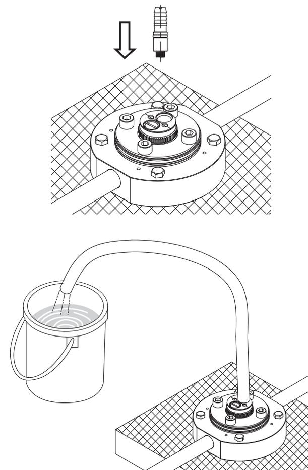
※ Если не промыть грязь, песок и т. д. в трубах горячего и холодного водоснабжения, это может засорить сетчатый фильтр. Возможны следующие проблемы: (1) Недостаточный расход воды на выходе. (2) Температура воды не будет регулироваться плавно.
