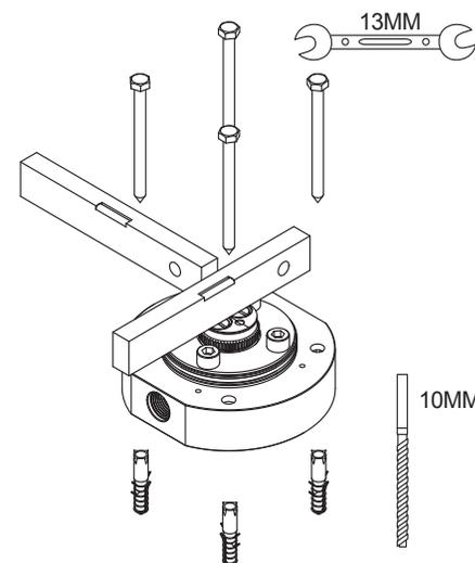
※ Направление излива смесителя противоположно красному индикатору на основании. После проверки места установки ванны закрепите основание в соответствии с определенным направлением установки.
