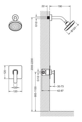
Определите точное место установки смесителя. Рекомендуем устанавливать смеситель на высоту 900-1100 мм от уровня пола. Подведите водопроводные трубы к смесителю. Убедитесь, что подача горячей воды слева, а холодной справа.
