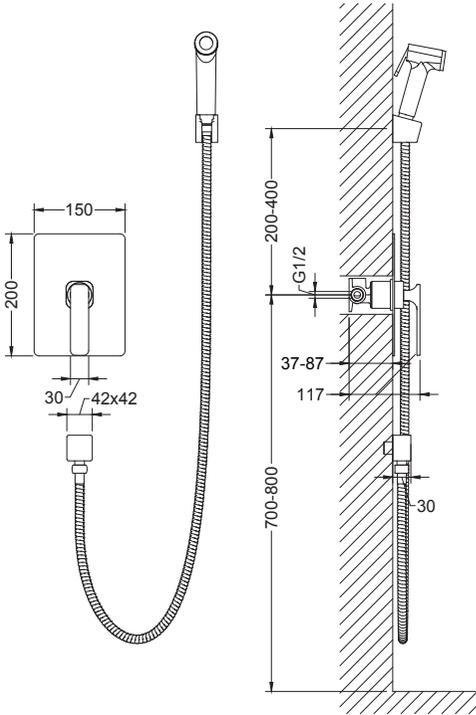
Определите точное место установки смесителя.
