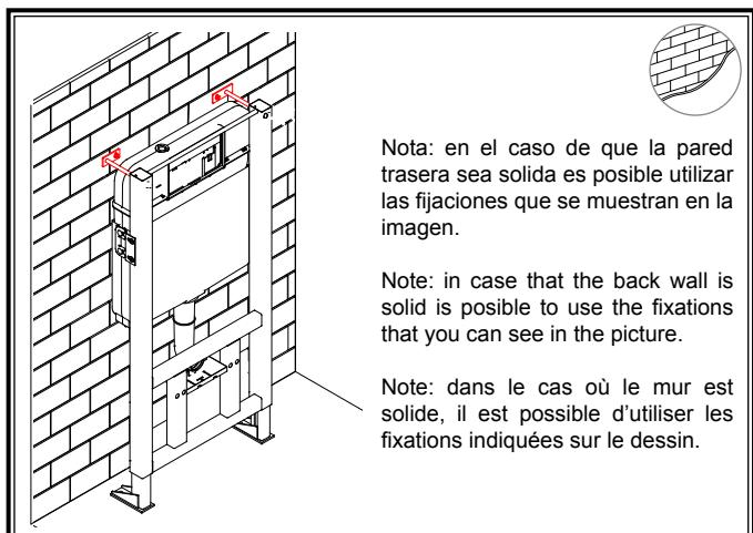
Note: en el caso de que la pared trasera sea sólida es posible utilizar las fijaciones que se muestran en la imagen.
