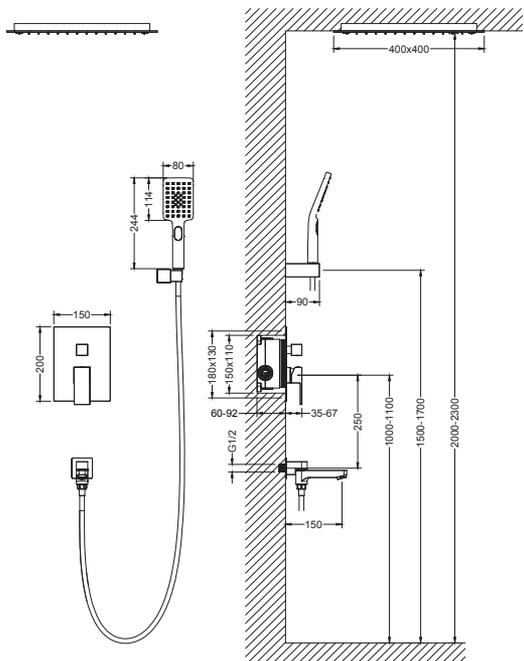
Определите точное место установки смесителя. Рекомендуем устанавливать смеситель на высоту 900-1100 мм от уровня пола.
