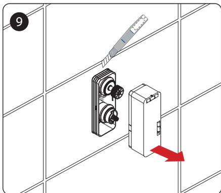
Следуя линии разреза на коробке, отрежьте выступающую часть коробки. Удалите защитную крышку.
