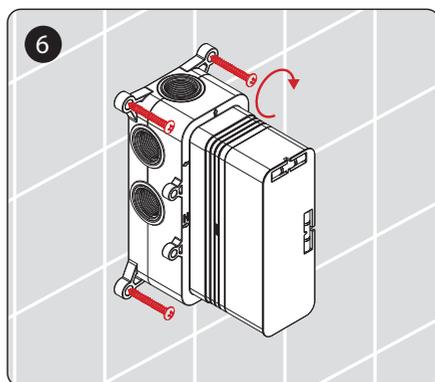
Используя уровень, установите блок на стене и отметьте положение крепежных выступов, просверлите отверстия и прикрепите встроенный блок к стене с помощью винтов и анкеров.
