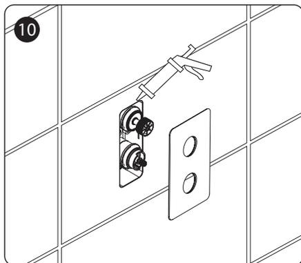
После укладки облицовки нанесите водостойкий герметик на край плитки.
