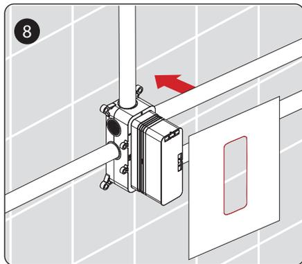
Используя шаблон, вырежьте отверстие в плитке, затем соответствующим образом уложите плитку. Не снимайте защитную крышку до завершения всех отделочных работ. Это защитит блок управления от попадания пыли.
