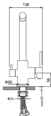
Промойте трубы для подачи воды, чтобы удалить инородные вещества. Подключите подачу воды, убедитесь, что подача горячей воды слева, а холодной справа. Включите воду и проверьте работу смесителя на предмет утечек.
