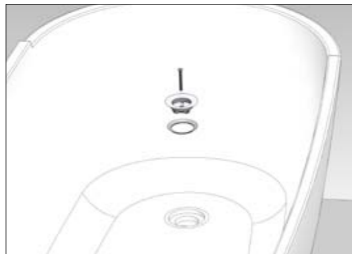
11 - Fissare la ghiera alla piletta mediante l'apposita vite; stringere fino a schiacciare la guarnizione. 11 - Fit the ring nut to the drain by the screw included in the packing; tighten the screw until the gasket is compressed.
