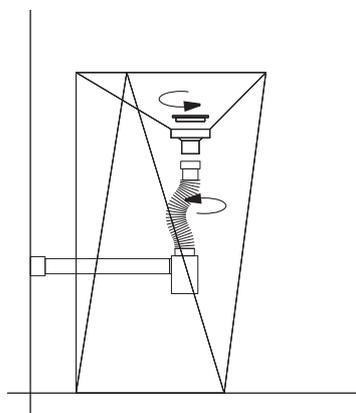
3. Fissare il sifone alla piletta, sostituire la curva di scarico con il manicotto dritto e fissarlo alla braga a muro.
