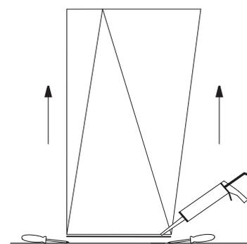
5. Utilizzando dei cunei (tipo 2 cacciaviti) sollevare il lavabo quanto basta per posizionare il silicone alla base; togliere i supporti e il silicone in eccesso. Lift the washbasin using 2 levers (for example 2 screwdrivers) to put the silicone on the base of washbasin; take away the levers and the silicone in excess.
