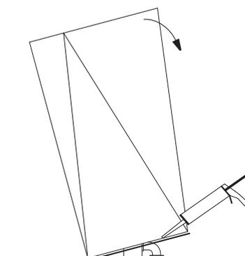
1. Sdraiare il lavabo sul pavimento e installare il sifone. **ATTENZIONE:** durante il processo, per evitare scheggiature agli angoli, si consiglia di appoggiarlo su un foglio di cartone.
