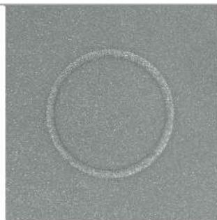
Желательно делать отверстие при помощи коронки 35-го диаметра с алмазным напылением с ОБРАТНОЙ стороны мойки. Отверстие выбивать не нужно, необходимо немножко досверлить.
