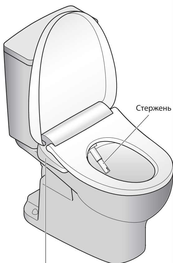
Сливной вентиль водяного фильтра
