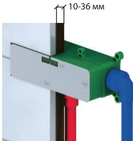
Вырежьте отверстие в полой стене, соответствующее размеру монтажной коробки в желаемом месте установки смесителя.
