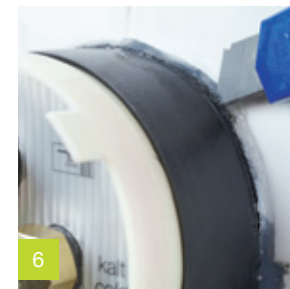
6 Удаление излишней части корпуса.
